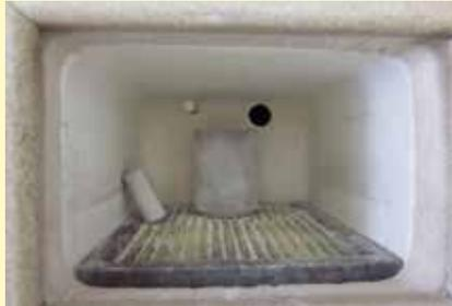
El proceso de pre calentamiento para fundir la cera y controlar la expansión de la masa de revestimiento se lleva a cabo en el horno de pre calentamiento del laboratorio (entre 630 °C y 850 °C).
