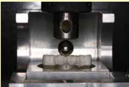
Dispositivo del ensayo para medir la resistencia a la rotura en la máquina de ensayos universal "Zwick". Las fuerzas compresoras se aplican a través de una bola de metal en el centro de los elementos intermedios.
