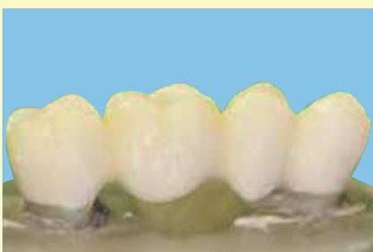
Puente de 4 elementos de **BioHPP** revestido con visio.lign adaptado de forma móvil con Vario-Link II antes de la prueba de simulación de la masticación.
