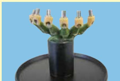
Los aditamentos modelados terminados se fijan en el formador de base. A continuación se reviste la mufra con la masa de revestimiento brevest for 2 press, se calienta adecuadamente el horno de precalentamiento y se procede al recubrimiento con BioHPP en el equipo de colado al vacío for 2 press.
