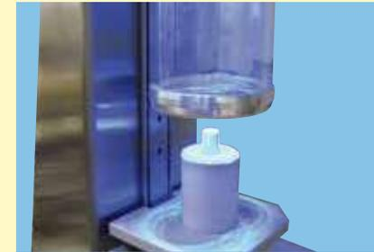
La finalización del proceso automático de moldeo al vacío se indica mediante una señal acústica y una luz de LED azul. A continuación el técnico dental podrá proceder a extraer la mufla del revestimiento.
