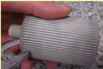
Pasados 35 minutos puede extraerse el objeto trasferido a **BioHPP**. Un breve baño en agua para liberarlo de polvo facilita asimismo la extracción. Los restos finos de masa de revestimiento se eliminan con un equipo de arenado fino aplicando óxido de aluminio de 110  $\mu\text{m}$  a una presión máx. de 3 bar.
