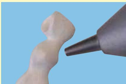
La estructura para el puente se arena con un grano de 110  $\mu\text{m}$  y una presión de 2-3 bar. La distancia de la salida del haz al objeto no será inferior a 3 cm.
