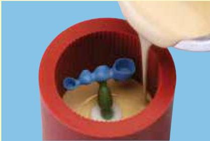
El modelado de cera se reviste con una masa de revestimiento especial ligada con fosfato comprobando que la concentración del líquido sea la indicada.
