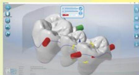
Entre los diversos automatismos de MillBox, cuando se ha incluido cada restauración, se crean los conectores de soporte necesarios para el proceso de mecanizado, identificando automáticamente su posicionamiento. En esta etapa, MillBox muestra la línea del ecuador que indica la mejor posición para insertar el pin de soporte. MillBox resalta la aparición de una posible retención cuando se inserta o se reubica un conector.
