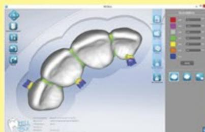
Durante el cálculo de las estrategias de fresado, tomamos en cuenta la estructura total de la máquina (fresadora, spindle, etc) Cualquier ruta de fresado que se detecte que causa una colisión, es automáticamente borrada. Una característica especial muestra las restauraciones terminadas presentando las partes que no pudieron fresarse.
