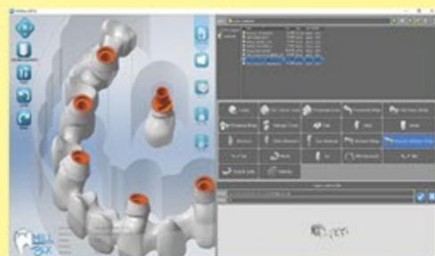
En MillBox es posible importar cualquier tipo de restauración dental (corona, puente, etc.) de cualquier CAD Abierto. El reconocimiento del tipo de objeto y la morfología está completamente automatizado, independientemente del sistema CAD utilizado. Las características automáticas se aplicarán a cada objeto importado (pines de soporte, detección de líneas de margen, desplazamiento, orientación, etc.), así como la posición optimizada en relación con la máquina utilizada.
