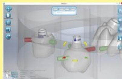
MillBox automáticamente identifica características espaciales en restauraciones, que requieren operaciones de fresado específicas (perforaciones, conexiones internas y externas de interfaces para implantes, aditamentos locator, etc). La anidación de las restauraciones que se van a fresar y su posición en el bloque, aunque se llevan a cabo automáticamente, pueden ser completamente ajustadas directamente en la pantalla usando flechas de ajuste localizadas convenientemente alrededor de las partes.
