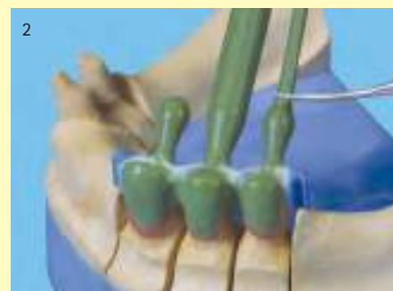
Con la espátula de cera se retirará el soporte después de haber fijado la cámara de rechupado.
