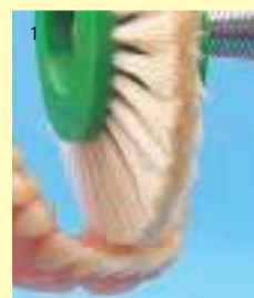
El cepillo más fino con un radio grande, agiliza el pulimento en completas inferiores de resina (REF 350 0034 0).
