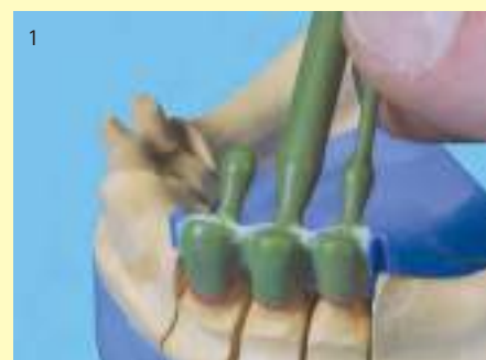
El soporte agiliza la colocación de la cámara de rechupado.
