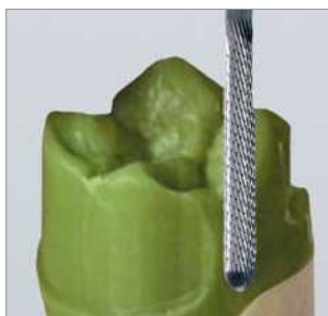
Fresaggio parallelo di una corona di cera. Fresado paralelo de una corona de cera. Fresagem paralela em cera.
