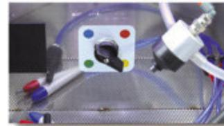
La válvula de cambio de vaso está situada en el interior de la cámara. El criterio de colores permite identificar y seleccionar rápidamente el vaso deseado. Para el ajuste inicial del chorro puede emplearse una sufridera de goma también situada en el interior de la cámara.
