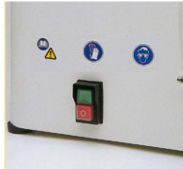
Interruptor de seguridad. Ante una falta de suministro eléctrico desconecta la RH3 teniendo que rearmar manualmente (evitando arranques incontrolados).
