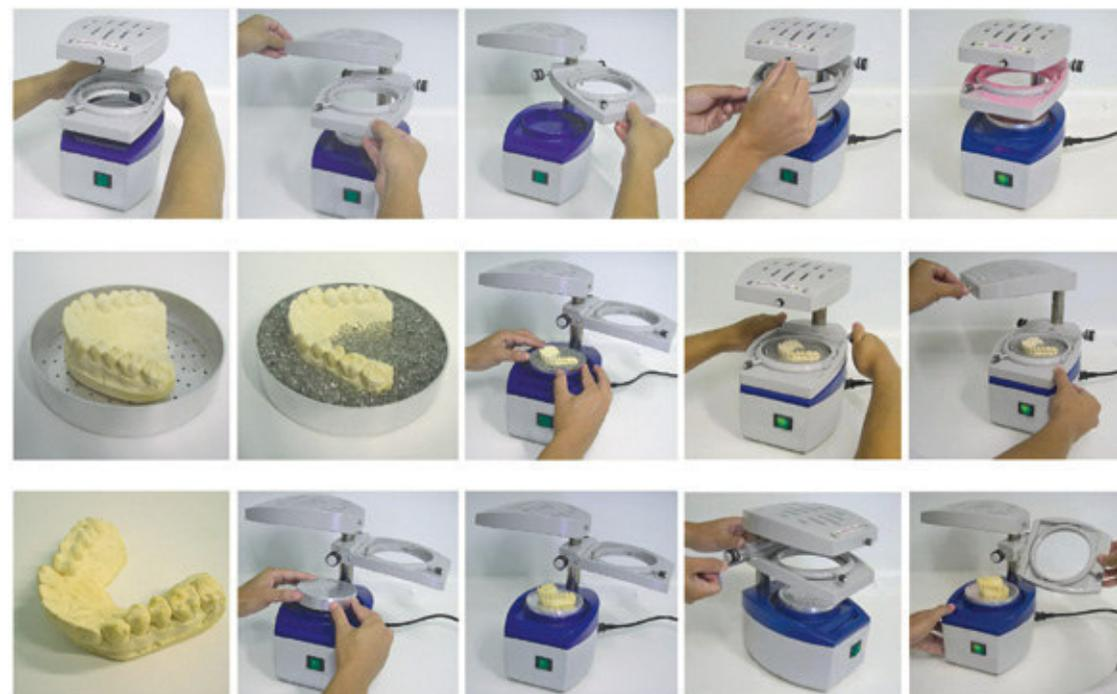
Sencilla, económica y de atractivo diseño. Dispone de un potente motor de aspiración con conexión automática al bajar el portaplanchas. La resistencia es de carbono, lo que permite un calentamiento suave y uniforme del material a conformar. Es válida para planchas cuadradas (formato estándar de 127 mm. de lado). La máquina se suministra con un portamodelos plano y con una cesta que, rellena con granalla (se incluye un bote con el equipo), reduce la profundidad de conformado.
