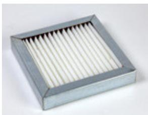
La unidad de aspiración Eolo Plus cuenta también con una segunda etapa de filtrado en la que se monta un filtro tipo "absoluto" (HEPA) de alto rendimiento (99,9998 %). La combinación de las dos etapas de filtrado permite aspirar materiales de todo tipo, incluidos abrasivos como el óxido de aluminio o de silicio.
