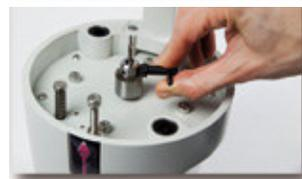
Los detalles cuentan mucho a la hora de diseñar una buena perforadora de pines: el sistema de anclaje de fresa tiene que ser fácil de liberar. En el caso de la perforadora Atlas, bastan apenas unos pocos segundos para sustituir la fresa o ajustar su altura. Por su parte, La mesa también permite una sencilla regulación de la profundidad de taladro. Simplemente hay que girar un tornillo para ajustar el valor a la altura deseada.
