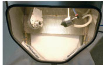
La arena almacenada en la tolva de la máquina es absorbida por la aspiración del Venturi y luego es inyectada a presión por la boquilla. Posteriormente vuelve a caer otra vez en la tolva.
