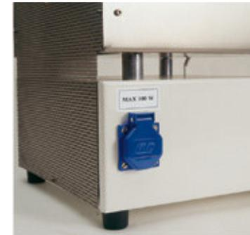
Una práctica toma de corriente permite el funcionamiento sincronizado del horno junto a una unidad de extracción. Pudiéndose programar su desconexión automática entre los 75° C y los 850° C. Cuando la temperatura se encuentra por encima de los 850° C, el control desconecta automáticamente la alimentación de la toma.
