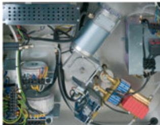
Los componentes empleados son de primera calidad y se encuentran ensamblados formando módulos autónomos. Con este concepto de diseño se simplifican enormemente las labores de mantenimiento: basta con soltar el módulo dañado y sustituirlo por otro nuevo, operación que puede llevarla a cabo cualquier Servicio Técnico con un coste reducido.
