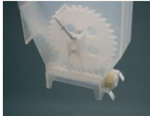
Sistema de dosificación Smarttank: el mecanismo dosificador se encuentra integrado en el propio depósito, por lo que en caso de obstrucción o desgaste, puede ser reparado en pocos minutos por el propio usuario. El mecanismo se compone de un husillo, un rodete y un actuador de golpeo muy accesibles.
