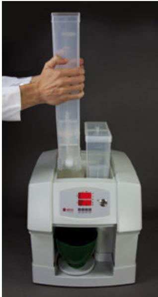
Tanques de almacenamiento de polvo fácilmente desmontables: lo que simplifica las labores de carga de polvo y de cambio de cartucho por otro con distinto tipo de escayola. Con la Dosificadora Boomerang, le bastará unos pocos segundos para cambiar de depósito y por consiguiente, de material a dosificar.
