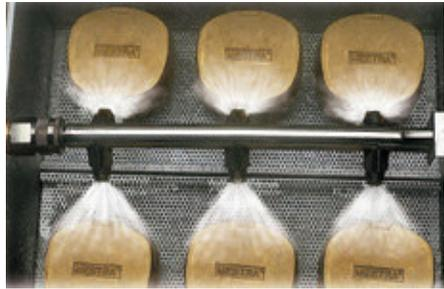
El sistema de lavado por 6 inyectoros de agua a presión nos aseguran un buen escaldado de las muflas y un desencerado perfecto.
