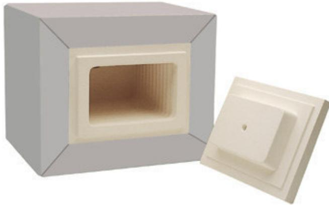
La mufla está fabricada en material cerámico con las resistencias de caldeo arrolladas a lo largo de las caras superior, inferior y laterales. Se consigue así una distribución de temperaturas uniforme en el interior. Las caras exteriores de la mufla se encuentran aisladas térmicamente con un recubrimiento de silicato de zirconio.
