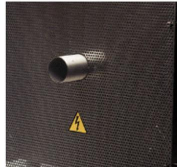
El flujo de gases en el interior de la mufla está minuciosamente estudiado. En la puerta se encuentra un orificio de entrada de aire, y en la parte posterior un tubo de ventilación, ambos con secciones calibradas. De esta manera se consigue renovar el aire en el interior sin reducir el rendimiento térmico del horno ni originar diferencias de temperaturas en la mufla.
