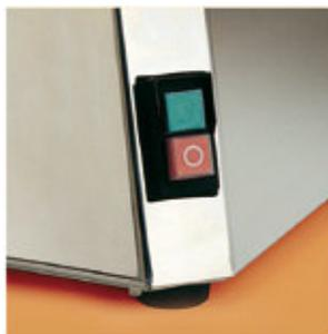
Interruptor de seguridad acorde a la normativa de Seguridad en Máquinas. En caso de corte accidental en suministro de red, es necesario un rearme manual.
