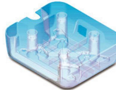
El diseño del chasis cuenta con innumerables nervios y refuerzos que lo dotan de una rigidez excepcional que nada tiene que envidiar a los fabricados en chapa de acero. Además, está construido en una sola pieza, lo que mejora la rigidez. A efectos prácticos esto se traduce en una exquisita suavidad de funcionamiento y baja transmisión de vibraciones y ruido.
