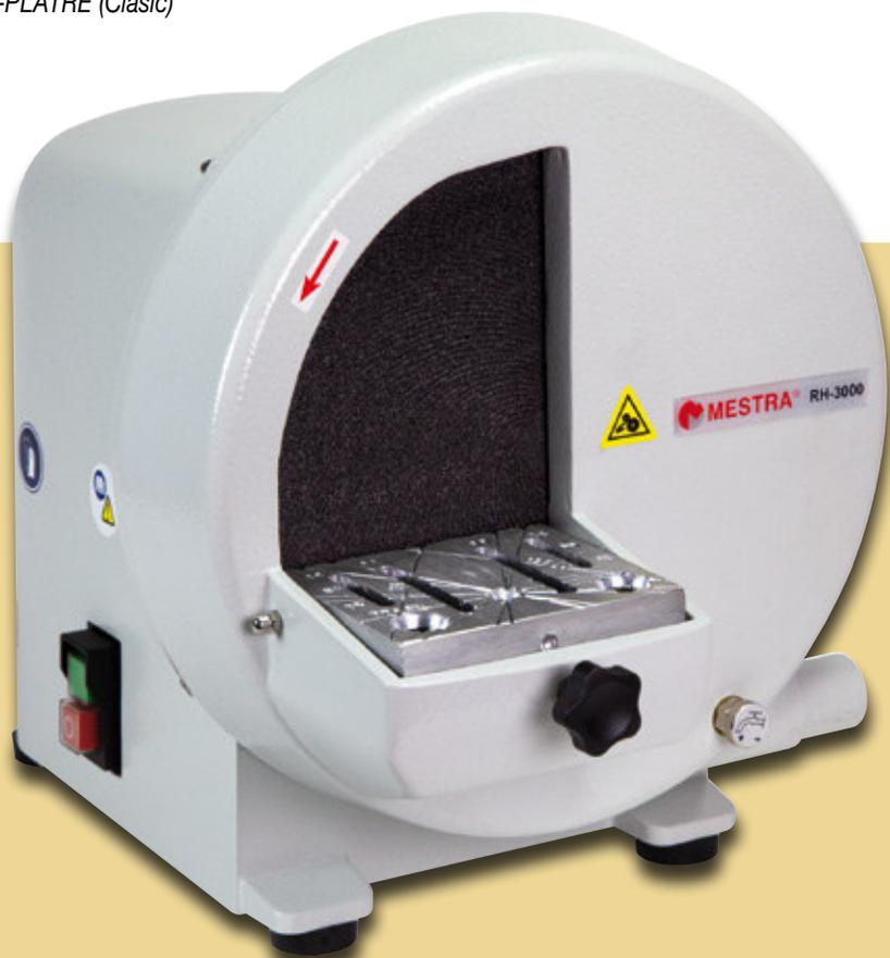
La recortadora de modelos MESTRA es una máquina fuerte y robusta, lleva incorporado en ella todas las mejoras e innovaciones que una máquina de sus características necesita. Su robustez se ve a simple vista y su peso de más de 21 Kg (máximo en máquinas de su categoría) y el hecho añadido a ir apoyada sobre gomas antideslizantes la hacen estable al empuje de refrentado.
