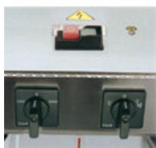
El Box incorpora 2 interruptores, más uno de seguridad. El 1° acciona el motor a 1.500 ó 3.000 r.p.m.. El 2° acciona luz o luz y aspiración. El interruptor de seguridad interrumpe la llegada de tensión al motor si ha habido un corte de suministro eléctrico teniendo que rearmarse manualmente.
