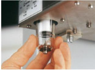
La batidora de vacío Koala cuenta con un filtro neumático tipo cartucho de alta eficiencia, que protege a los elementos mecánicos del polvo y la suciedad.
