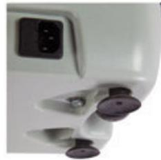
Las patas suponen un importante avance en la reducción de vibraciones. Tradicionalmente, las patas de un vibrador se diseñaban como ventosas para que quedasen fijadas a la mesa; o como pivotes huecos de gran flexibilidad. Los ingenieros de MESTRA consiguieron aunar ambos enfoques diseñando una patas con final en forma de ventosa y un tronco hueco. El resultado de tan ingeniosa solución es sorprendente: las vibraciones y ruido transmitidos a la mesa se reducen drásticamente.
