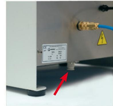
El aire se filtra antes de ser introducido en el circuito neumático. El purgador del filtro tiene fácil acceso, y se puede hacer que funcione en modo automático.
