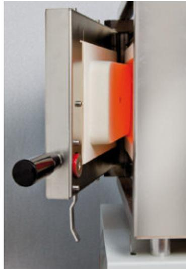
El sistema de cierre de puerta mediante imán resulta práctico y sencillo. Un sensor de seguridad detecta la apertura de la puerta, desconectando las resistencias mientras permanece abierta.
