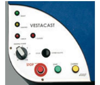
El cuadro de control es de tipo sinóptico permitiendo un manejo intuitivo. Tres botones de mando y un potenciómetro con el que se regula la potencia de fundido, son suficientes para realizar el colado. La temperatura de fusión puede llegar a alcanzar los 1750 °C. El estado del proceso se visualiza a través de cuatro lamparitas indicadoras.
