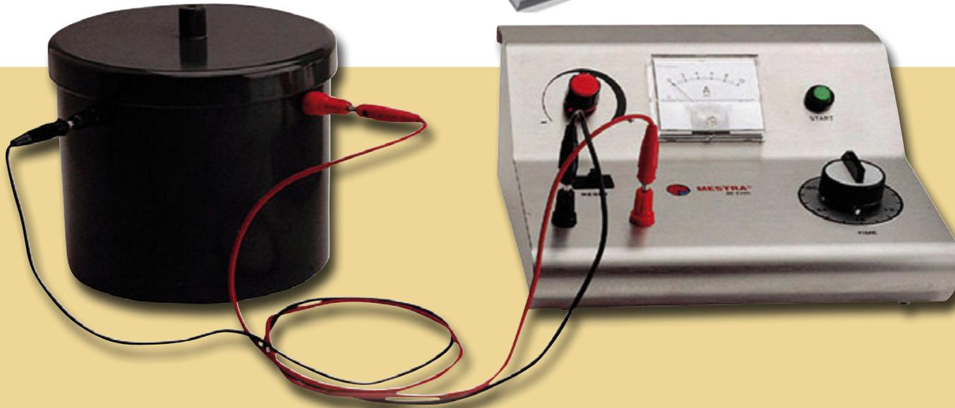
El pulidor electrolítico está especialmente diseñado para los laboratorios dentales. Se caracteriza por su fabricación en acero inoxidable y por la capacidad importante de la cuba. Se pueden pulir hasta tres esqueletos simultáneamente. Dotada de un temporizador, se puede programar el pulido de 0 a 30'. Incluye un potenciómetro, un amperímetro, una seguridad térmica y un dispositivo visual de funcionamiento. Aparato de concepción sobria y de gran eficacia.
