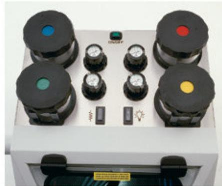
Cada uno de los vasos cuenta con su propio manorregulador y manómetro. En la parte central de la máquina se encuentran los mandos eléctricos: un interruptor de iluminación interior y un interruptor de las resistencias de calentamiento de la arena.
