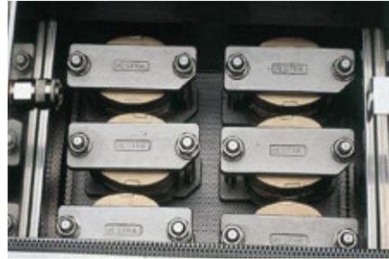
La amplia capacidad del compartimento, permite introducir 6 bridas con dos muflas cada una.
