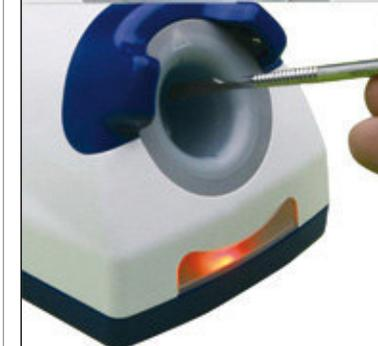
Si los sensores detectan la presencia de un instrumento se encenderá la luz roja, indicando que está funcionando la inducción.
