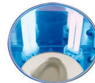
Un platillo giratorio mueve el material a polimerizar para que el baño luminoso llegue a todos los rincones y se distribuya uniformemente.
