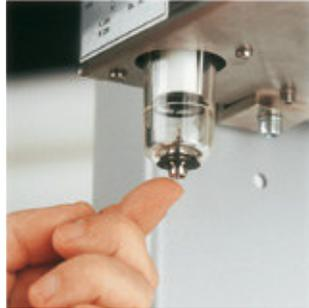
En caso de parada de la batidora de vacío por corte en la red de suministro eléctrico, es posible soltar la taza del cuerpo de la batidora (maniobra de emergencia), actuando manualmente sobre la válvula de descarga situada en la carcasa del filtro.
