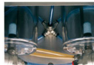
En el montaje del circuito neumático se han escogido elementos de alta gama. Destaca la precisión y suave accionamiento de la válvula distribuidora de 5 vías.
