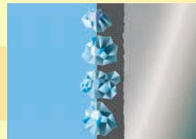
Cristales de diamante en una ligazón metálica galvanizada.
