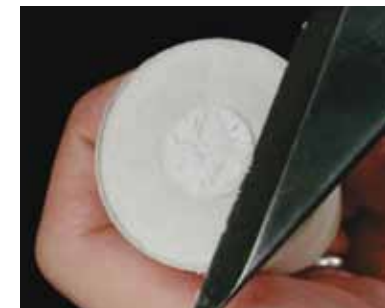
Retire el botón del revestimiento que se ha creado con el tope de distribución.
