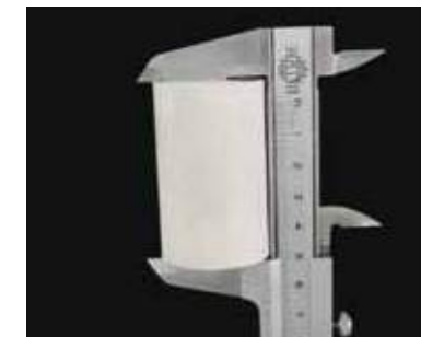
Nivele con cuidado el anillo, de tal manera que la parte inferior y superior estén perpendiculares a los lados del anillo.
