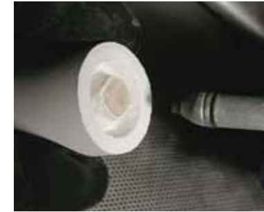
Retirada tosca del revestimiento
