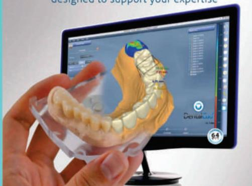
• El Dental Cad provee una serie de herramientas para modelar un amplio rango de restauraciones. • Permite realizar tareas manuales o semi automáticas. • Puede sugerir parámetros óptimos de reducción de la anatomía limitados al espesor mínimo del material y permite la corrección interna de la superficie basado en el radio de la herramienta de fresado.
